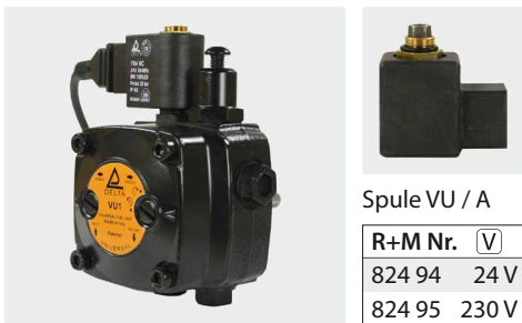
Pumpe VU. Ein- oder Zweistranginstallation. Kabel 700 mm. Druck einstellbar 6 - 18 bar
