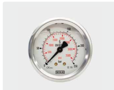
Ø 50 mm. 1/4" AG. Gehäuse Edelstahl. Eingang hinten. Typ WIKA
