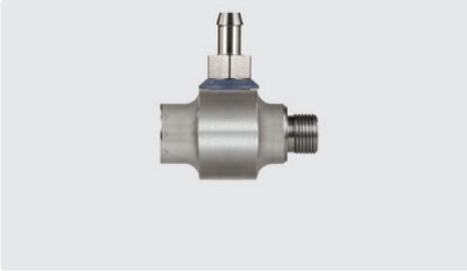
3/8" IG : 3/8" AG : Tülle 9 mm. Injektor ST-160 für Chemie- und Schaumanwendungen. Regulierung der Chemiedosierung erfolgt durch 10 auswechselbare Dosiereinsätze (0,5 - 2,0 mm).
