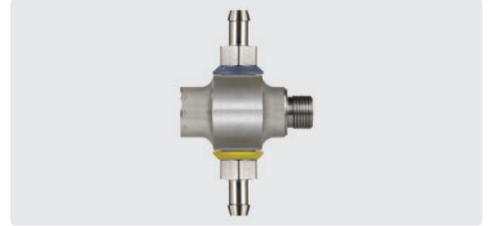
3/8" IG : 3/8" AG : 2 Tüllen 9 mm. Injektor für Chemie- und Schaumanwendungen. Der Injektor kann bis zu zwei Chemikalien gleichzeitig ansaugen/zumischen. Regulierung der Chemiedosierung erfolgt durch 2 x 10 auswechselbare Dosiereinsätze (0,5 - 2,0 mm).
