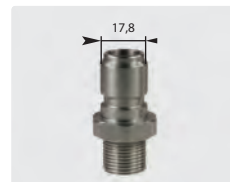
Coupleur mâle : mâle. Inox. Cône 60°. Max. 250 bar / 150 °C
