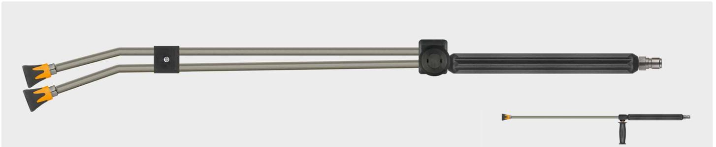
Stecknippel ST-3100. Strahlrohr aus Edelstahl, umspritzte Isolierung 300 mm, Ventil ST-54 seitlich und Düsenschutz ST-10 mit Niederdruckdüse & Muffe 1/4" IG. Max. 310 bar / 150 °C
