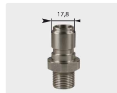
Stecknippel : AG. Edelstahl. 60° Dichtkonus. Max. 250 bar / 150 °C
