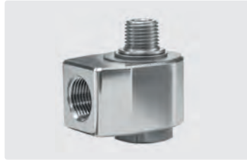
3/8" F : 1/4" M. DN 7. Max. 275 bar / 30 tr/min / 120 °C
