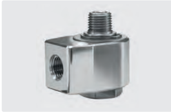
1/4" F : 1/4" M. DN 7. Max. 275 bar / 30 tr/min / 120 °C
