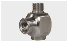
1/2" F : 1/2" M. DN 12. Max. 300 bar / 30 r.p.m. / 90 °C
