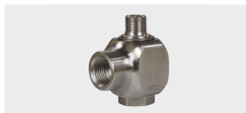
1/2" F : 3/8" M. DN 10. Max. 300 bar / 90 °C
