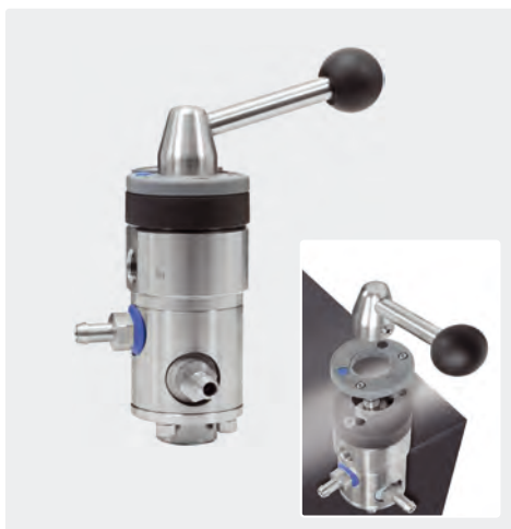
3/8" IG: 1/2" IG. Tülle 9 mm. Injektor ST-162 inkl. 10 auswechselbare Dosiereinsätze (0,5 - 2,0 mm) zur Regulierung der Chemiedosierung. Verbesserte Niederdruckschäumfähigkeit durch die symmetrische Lufteinblasung um die Diffusordüse. Max. 350 bar / 100 °C
