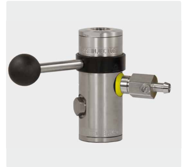
1/2" IG : 1/2" IG : Tülle 9 mm. Injektor ST-167 mit Dosierventil extreme. Max. 350 bar / 100 °C
