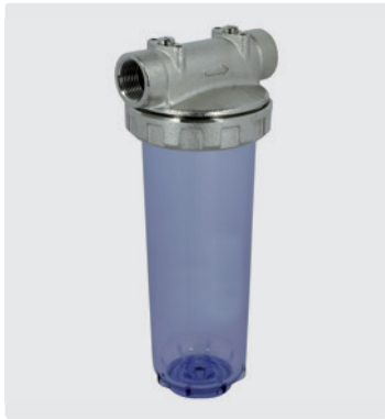
3-teilig. Entlüftungsstopfen. Kopf Messing vernickelt. Tasse Kunststoff. Max. 15 bar / 40 °C
