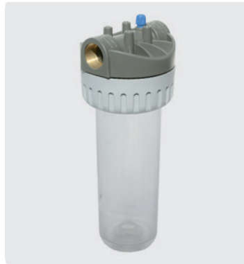
3-teilig. Entlüftungsstopfen. Innengewinde Messing. Max. 10 bar / 40 °C
