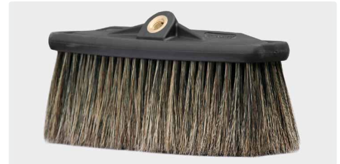
A= 270. B= 260 x 80 mm. Schweineborsten / Synthetik. Max. 40 l/min / 60 °C
