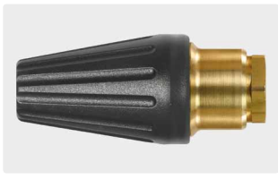
1/4" F. Spray angle 20°. 120 - 250 bar. Max. 100 °C
