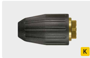
M1/8 F. Spray angle 20°. 200 - 350 bar. Max. 100 °C
