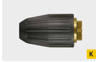
M1/8 IG. Spritzwinkel 20°. 200 - 350 bar. Max. 100 °C
