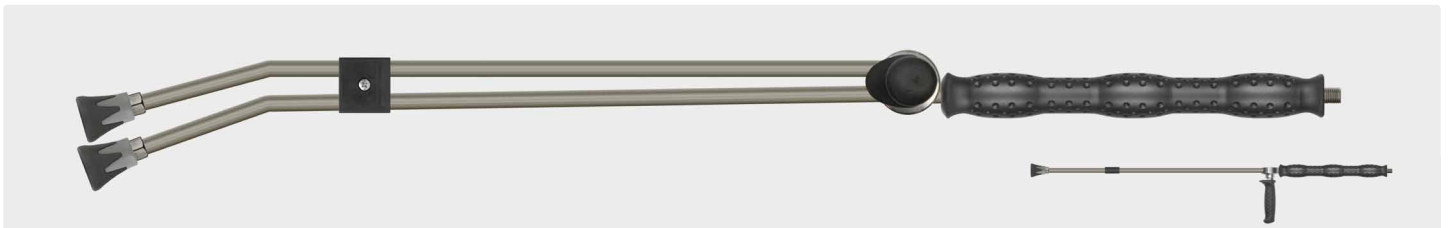
1/4" AG. Strahlrohr mit Isolierung ST-29 Cool & Compact, Ventil ST-54.2 seitlich und Düsenschutz ST-10 mit Niederdruckdüse. Max. 400 bar / 150 °C
