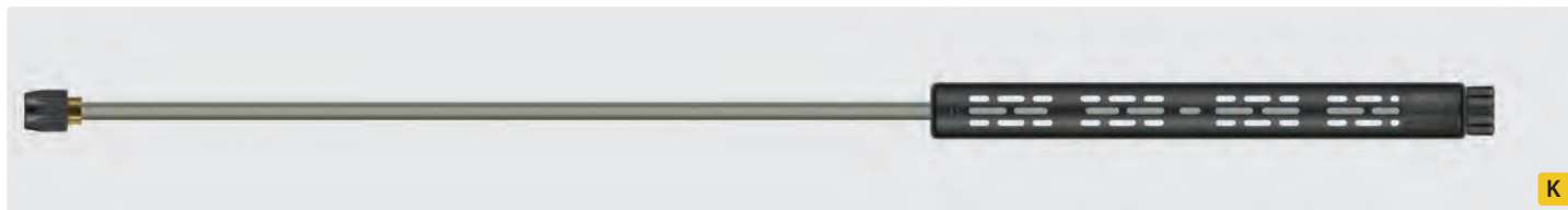
M22 F. Lances avec demi-coquilles ST-9 et porte-buse pastille, livrées sans buse. Max. 400 bar / 150 °C
