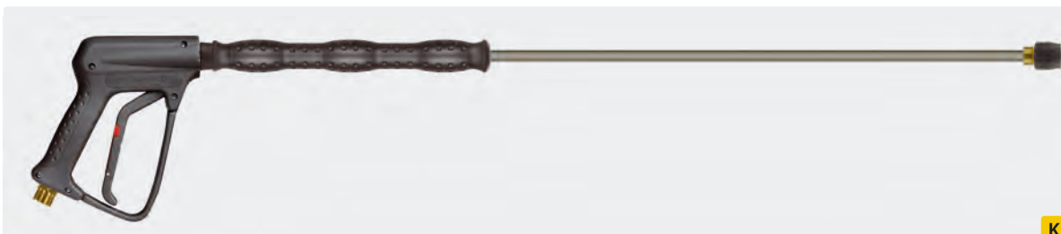
Professionelle Pistole R+M EcoLine No. ONE mit Strahlrohr 900 mm Stahl verzinkt, Isolierung ST-28 Cool & Compact 300 mm und Düsenschutz ohne Mundstück. Max. 250 bar / 45 l/min / 150 °C
