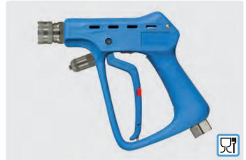
Pistolet professionnel avec retard à la fermeture gâchette. Pistolet avec coupleur ST-3100. Tout inox. Destiné à la pulvérisation de la mousse et autres produits dans l'industrie alimentaire. Standard industriel. Max. 60 bar / 100 l/min / 150 °C
