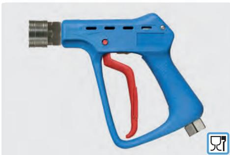
Pistolet professionnel High-Flow. Pistolet avec coupleur ST-45. Tout inox. Destiné à la pulvérisation de la mousse et autres produits dans l'industrie alimentaire. Max. 150 bar / 100 l/min / 150 °C
