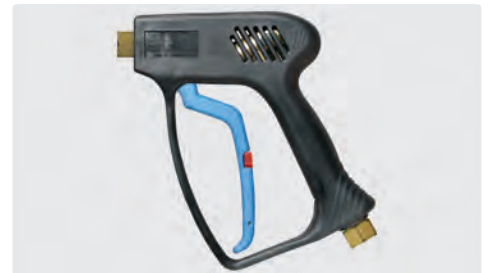
Pistolet professionnel. Version hors-gel avec clapet. Max. 275 bar / 45 l/min / 150 °C
