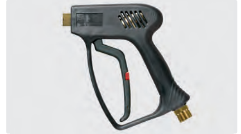
Pistolet professionnel. Max. 275 bar / 45 l/min / 150 °C
