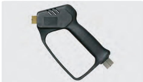
Pistolet professionnel sans clapet (passage libre). Max. 210 bar / 25 l/min / 150 °C
