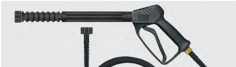
Pistolet professionnel avec manchon 340 mm, max. 210 bar / 25 l/min / 150 °C. Entrée / sortie M22 F. Équipé d'un flexible 6 - 160 avec 1 tresse synthétique, max. 160 bar / 20 °C
