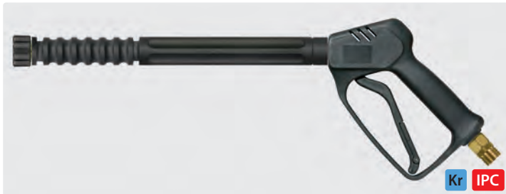
Pistolet professionnel avec manchon 340 mm et raccord manuel M22. Max. 210 bar / 25 l/min / 150 °C
