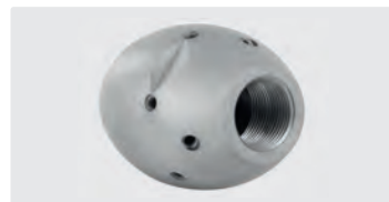
3/4"F. 6x 75° 3x 30° +1x 0°. 100-250 l/min. Pour \varnothing 150-300 mm. \varnothing Extérieur 50 mm. \boxplus 1.367 g.
