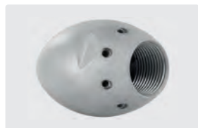
1"F. 8x 75° +1x 0°. 100-250 l/min. Pour \varnothing 150-300 mm. \varnothing Extérieur 62 mm. \boxplus 1.265 g.
