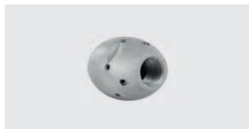
1/4"F. 6x 75° 3x 30° +1x 0°. 25-70 l/min. Pour \varnothing 75-150 mm. \varnothing Extérieur 30 mm. \boxplus 223 g.
