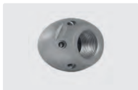
3/8"F. 6x 75° +1x 0°. 25-70 l/min. Pour \varnothing 75-150 mm. \varnothing Extérieur 35 mm. \boxplus 207 g.
