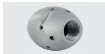
3/4" IG. 6x 75° 3x 30° +1x 0°. 100-250 л/мин. Для R Ø 150-300 мм. Наружный Ø 50 мм. Ⓢ 1.367 г.
