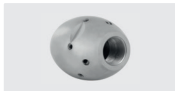
1/2" IG. 6x 75° 3x 30° +1x 0°. 80-140 л/мин. Для R Ø 120-250 мм. Наружный Ø 40 мм. Ⓢ 630 г.
