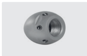
3/8" IG. 6x 75° +1x 0°. 25-70 л/мин. Для R Ø 75-150 мм. Наружный Ø 35 мм. Ⓢ 207 г.
