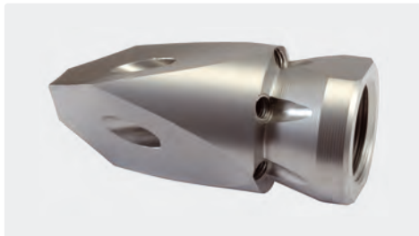
300 bar. 1/2" IG. \square 68 mm, \varnothing = 31 mm, \boxtimes 0,17 kg. Für Rohre > 60 mm. Seitliche Frontstrahlen mit gehärteten Edelstahl Düseneinsätzen.
