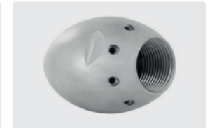
1" IG. 8x 75° +1x 0°. 100-250 l/min. Für \text{R} \text{D} 150-300 mm. Außen \text{D} 62 mm. \text{G} 1.265 g.
