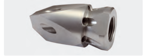
300 bar. 3/8" IG. \square 55 mm, \varnothing = 28 mm, \boxtimes 0,13 kg. Für Rohre > 50 mm. Seitliche Frontstrahlen mit gehärteten Edelstahl Düseneinsätzen.
