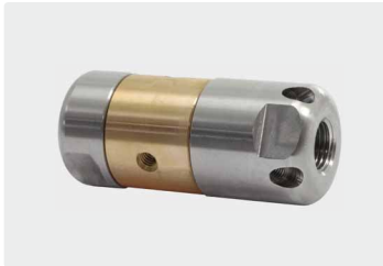
1/4" IG. 4. Bohrungen hinten. 3 Bohrungen seitlich. Außen \varnothing 30 mm. \boxtimes 314 g.
