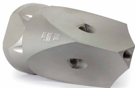
350 bar. 1/4" IG. \square 50 мм, \varnothing = 25 мм, \boxtimes 0,13 kg. Для труб > 30 мм. Боковые струи направлены фронтально через высверл. отверстия 0,5 мм
