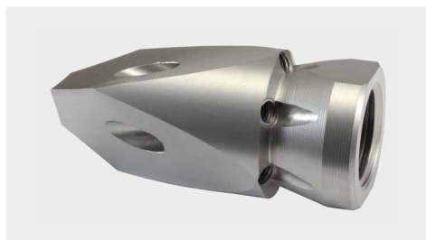
350 bar. 1/2" IG. \square 68 мм, \varnothing = 31 мм, \boxtimes 0,17 kg. Для труб > 60 мм. Фронтально направленные струи на боковых плоскостях с вставками из закаленной нерж. стали
