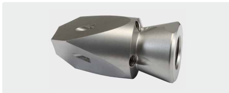
350 bar. 1/4" IG. \square 50 мм, \varnothing = 25 мм, \boxtimes 0,13 kg. Для труб > 30 мм. Боковые струи направлены фронтально через высверл. отверстия 0,5 мм
