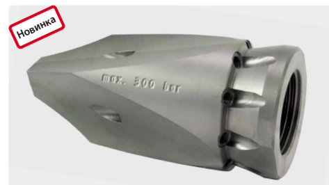
300 bar. 1" IG. \square 100 мм, \varnothing = 50 мм, \boxtimes 0,64 kg. Для труб > 100 мм. Фронтально направленные струи на боковых плоскостях с вставками из закаленной нерж. стали
