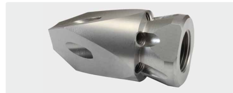
350 bar. 3/8" IG. \square 55 мм, \varnothing = 28 мм, \boxtimes 0,13 kg. Для труб > 50 мм. Фронтально направленные струи на боковых плоскостях с вставками из закаленной нерж. стали
