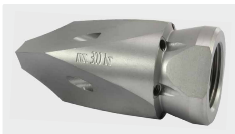
300 bar. 3/4" IG. \square 80 мм, \varnothing = 38 мм, \boxtimes 0,29 kg. Для труб > 60 мм. Фронтально направленные струи на боковых плоскостях с вставками из закаленной нерж. стали
