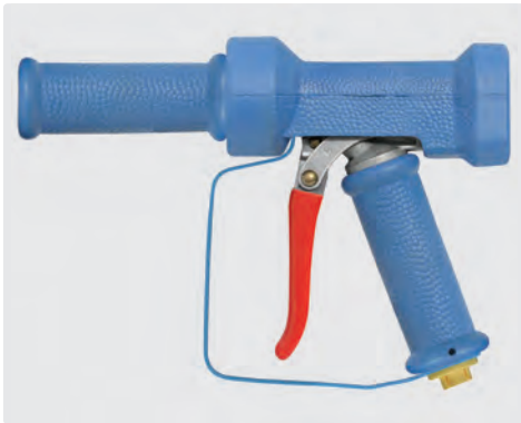
Pistolet avec jet à réglage progressif. Anse de sécurité. Max. 24 bar / 100 l/min / 95 °C
