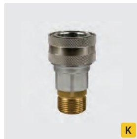
Coupleur femelle : M22 M. Laiton cadmié + laiton. Max. 250 bar / 150 °C
