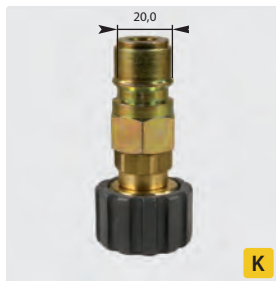
M22 F : coupleur mâle. Acier zingué + laiton. Max. 250 bar / 150 °C
