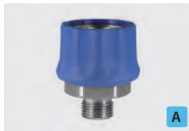
Coupleur surmoulé femelle : mâle. Inox. Max. 250 bar / 150 °C
