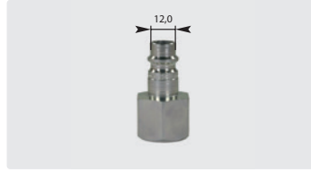
Stecknippel : IG. \varnothing 12 mm. Stahl vernickelt. Max. 200 bar / 100 °C
