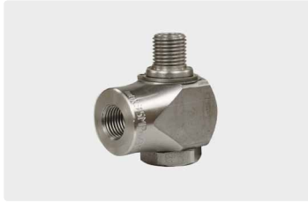
1/4" F : 1/4" M. Max. 400 bar / 30 r.p.m. / 90 °C
