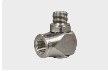
3/8" F : 3/8" M. Max. 400 bar / 30 r.p.m. / 90 °C
