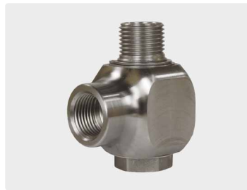
1/2" F : 1/2" M. DN 12. Max. 300 bar / 30 r.p.m. / 90 °C
