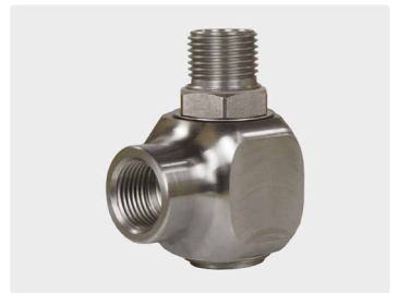
1/2" F : 1/2" M. DN 12. Max. 300 bar / 30 r.p.m. / 90 °C
