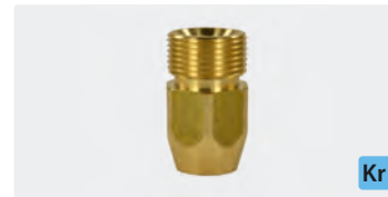
M22 AG : IG. Messing. Innensechskant. Max. 400 bar
