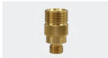
M22 AG : AG. Messing. Langbohrung. Max. 400 bar
