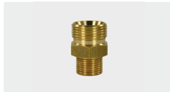
M22 AG : AG mit Konus (AGR). Messing. Max. 400 bar
