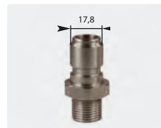
Stecknippel : AG. Edelstahl. 60° Dichtkonus. Max. 250 bar / 150 °C
