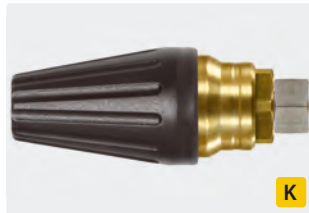
M18 IG. Spritzwinkel 20°. 200 - 400 bar. Max. 100 °C
