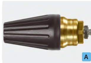
1/8" AG. Spritzwinkel 20°. 200 - 400 bar. Max. 100 °C
