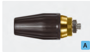
1/8" AG. Spritzwinkel 20°. 100 - 250 bar. Max. 100 °C
