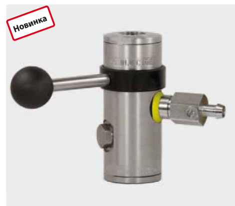
1/2" IG : 1/2" IG : Наконечник 9 мм. Инжектор ST-167 с дозирующим вентилем "extreme". Макс. 350 bar / 100 °C
