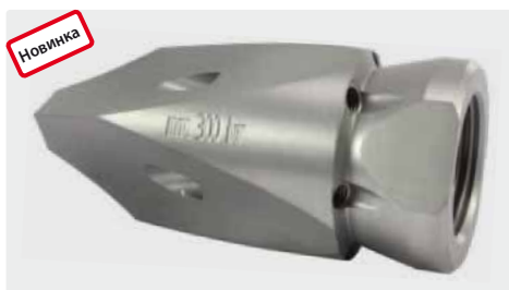
300 bar. 1/2" IG. Для труб > 60 мм. Фронтально направленные струи на боковых плоскостях с вставками из закаленной нерж. стали
