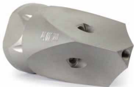
350 bar. 1/4" IG. Для труб > 30 мм. Боковые струи направленные фронтально через высверл. отверстия 0,5 мм
