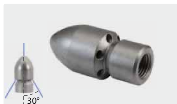
1/4" IG. Наружный \varnothing 25 мм. 6 отверстий сзади, с фронт. отверстием
