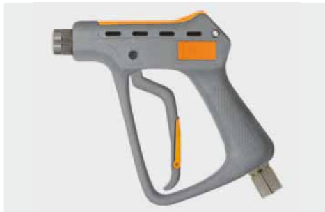
Профессиональный пистолет для больших потоков. Нерж. сталь. Индустриальный пистолет высокого давления для применения в области коммунальной техники, чистки каналов и промышленности. Поршень вентиля из закалённой нерж. стали. Вращ. соединение из нерж. стали. Макс. 350 bar / 200 л/мин / 150 °C
