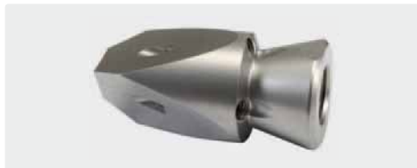
350 bar. 1/4" IG. Для труб > 30 мм. Боковые струи направленные фронтально через высверл. отверстия 0,5 мм
