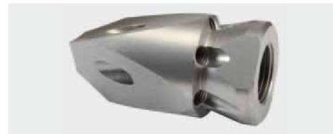
350 bar. 3/8" IG. Для труб > 50 мм. Фронтально направленные струи на боковых плоскостях с вставками из закаленной нерж. стали
