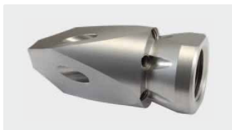
350 bar. 1/2" IG. Для труб > 60 мм. Фронтально направленные струи на боковых плоскостях с вставками из закаленной нерж. стали
