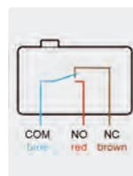
**Contacts :** Fils rouge et marron = normalement fermé / fils rouge et bleu = normalement ouvert. Pour un usage avec deux pressostats, les fils bleus servent de commande (commun).
