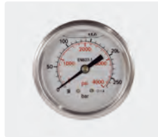
∅ 63 mm. 1/4" M. Boîtier inox. Entrée latérale
