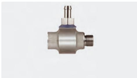
3/8" F : 3/8" M : cannelé 9 mm. Injecteur ST-160 pour produit mousse. Le dosage produit est calibré par l'intermédiaire d'un jeu de 10 gicleurs de dosage insérables (0,5 - 2,0 mm).
