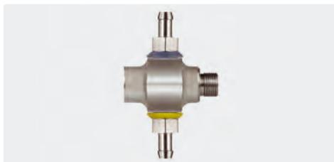
3/8" F : 3/8" M : 2 cannelés 9 mm. Injecteur pour produit mousse. L'injecteur peut aspirer et mélanger simultanément deux produits différents. Le dosage produit est calibré par l'intermédiaire de 2 jeux de 10 gicleurs de dosage insérables (0,5 - 2,0 mm).
