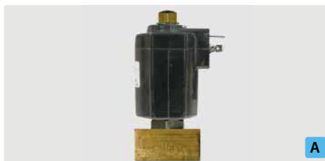
1/4" IG. NW 1,2 mm. Magnetventil ohne Steckdose. Druckbereich 0 - 180 bar. Max. 90 °C
