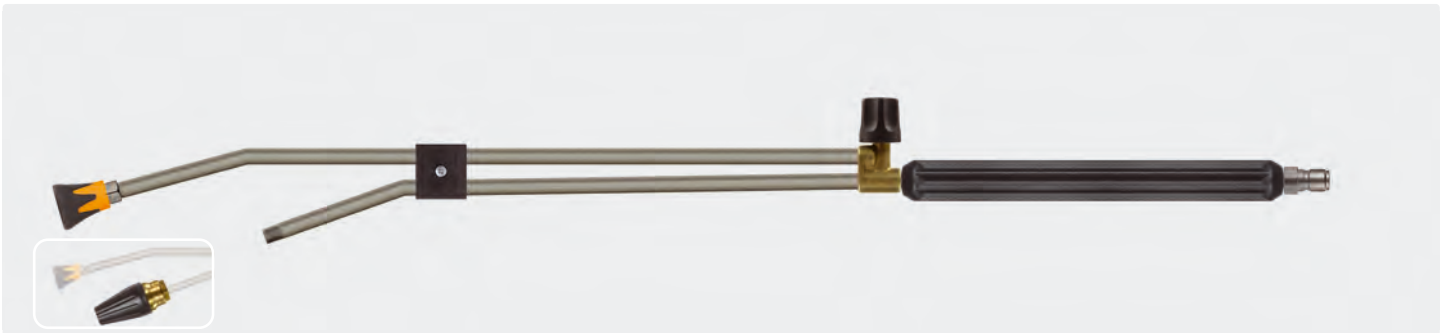
Coupleur ST-3100. Lance surmoulée 300 mm en acier inoxydable, robinet vertical ST-53, porte-buse ST-10, livrée avec buse basse-pression, tube 1/4" M pour montage rotabuse. Livrée sans rotabuse. Max. 250 bar / 150 °C
