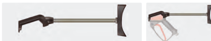
La nouvelle directive UE prescrit l'usage obligatoire d'une crosse de maintien à partir d'une force de recul supérieure à 150 N.
