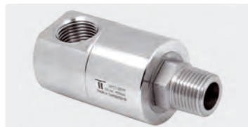
DGE 90°. Corps en laiton cadmié. 1 seul roulement à billes. Max. 275 bar
