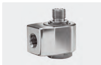
1/4" F : 1/4" M. DN 7. Max. 150 bar / 30 tr/min / 90 °C
