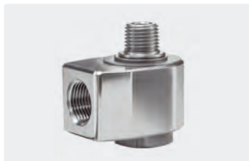
3/8" F : 1/4" M. DN 7. Max. 275 bar / 30 tr/min / 120 °C
