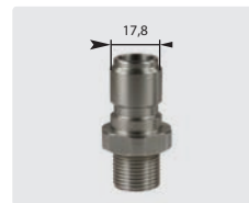
Stecknippel : AG. Edelstahl. 60° Dichtkonus. Max. 250 bar / 150 °C
