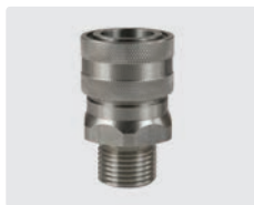
Kupplung : AG. Edelstahl. 60° Dichtkonus. Max. 250 bar / 150 °C
