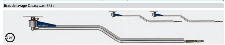
Acier inoxydable. Prêt-à-brancher, muni de 2 raccords tournants de haute qualité, équipé d'un flexible de liaison professionnel avec ressort anti-courbure et man-chette intégrée. Palier équipé de 2 roulements à billes sans entretien. Spécialement conçu pour le montage en tandem de 2 bras de lavage. Max. 275 bar / 90 °C
