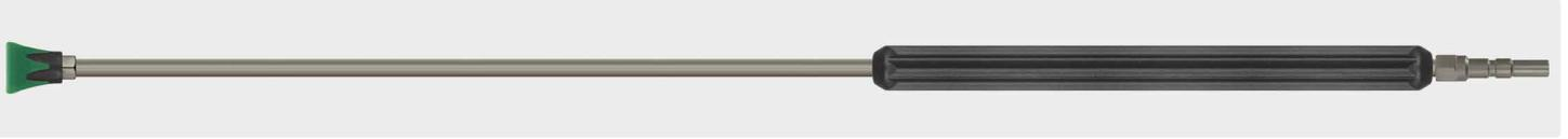
Stecknippel KW. Strahlrohr aus Edelstahl, umspritzte Isolierung 400 mm und Düsenschutz ST-10 ohne Düse. Max. 400 bar / 150 °C
