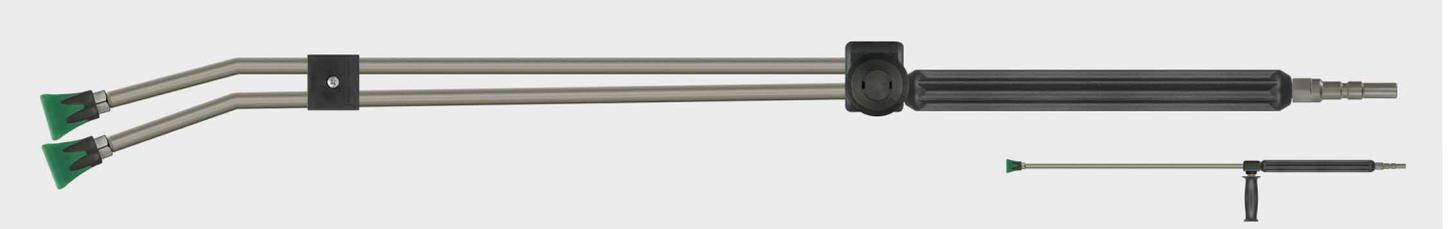
Stecknippel KW. Strahlrohr aus Edelstahl, umspritzte Isolierung 300 mm, Ventil ST-54 seitlich und Düsenschutz ST-10 mit Niederdruckdüse & Muffe 1/4" IG. Max. 310 bar / 150 °C
