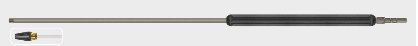
Stecknippel KW. Strahlrohr aus Edelstahl, umspritzte Isolierung 400 mm und 1/4" AG Anschluss für Rotordüsen. Strahlrohre werden ohne Rotordüsen geliefert. Max. 400 bar / 150 °C
