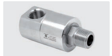
DGEI 90°. Gehäuse Edelstahl. 3-fach gelagert. Max. 350 bar
