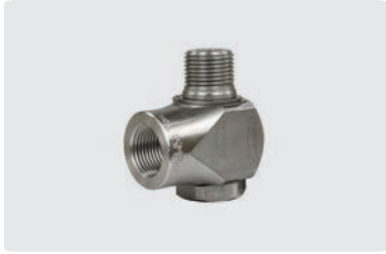
3/8" F : 3/8" M. DN 6. Max. 400 bar / 30 r.p.m. / 90 °C
