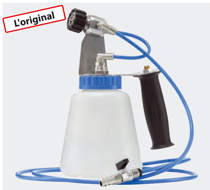
Brumisateur à froid ST-83. Pour le raccordement à air comprimé de 3 bar, 180-220 l/min. Acier inoxydable/PVC
