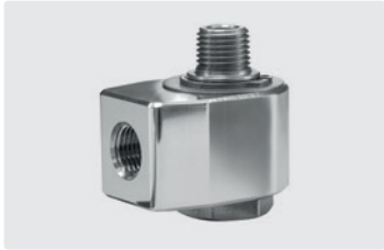
1/4" IG : 1/4" AG. DN 7. Max. 275 bar / 30 U/min / 120 °C
