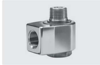
3/8" IG : 3/8" AG. DN 7. Max. 275 bar / 30 U/min / 120 °C
