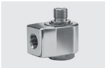
1/4" IG : 1/4" AG. DN 7. Max. 150 bar / 30 U/min / 90 °C
