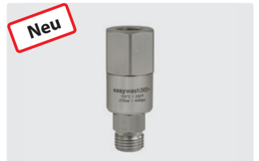
1/4" IG : M14 AG. Max. 275 bar / 120 °C
